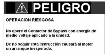
**Nota: Modo JP1 instalado- En el modo bypass de emergencia, esta no es una protección** de sobrecarga a menos que de forma separada, un relevador de sobrecarga térmico (opcional o suministrado por el cliente) sea instalado.
